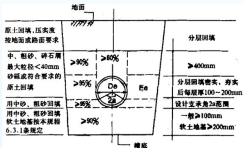
6.1埋地管道安装后应复测管道高程（管道高程允许偏差±25mm），合格后方可进行回填。
